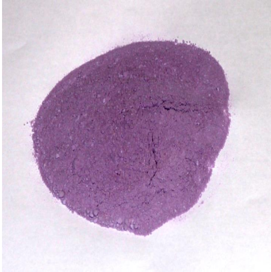
Рис. 8. Прекурсор, полученный в результате адсорбции карбоксилата кобальта на комбинированном минеральном носителе
