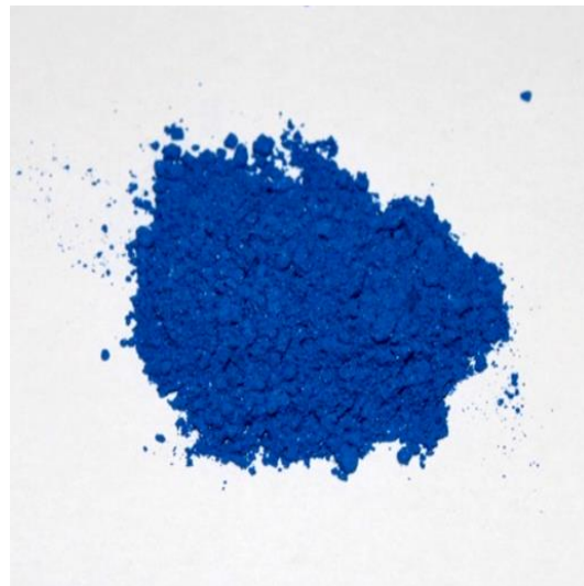
Рис. 10. Ультрадисперсный алюмокобальтооксидный пигмент на основе мезопористого ксонотлита, полученный с применением золь-гель и экстракционно-пиролитического методов
