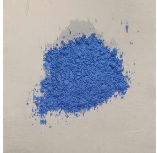
Рис. 9. Композиционный алюмокобальтооксидный пигмент на волластонитовой основе, полученный с применением экстракционно-пиролитического метода
